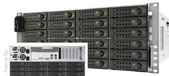
rapidNAS JSS224-G8 mit vier 10GbE-Ports und 15 TByte Nutzkapazität.
