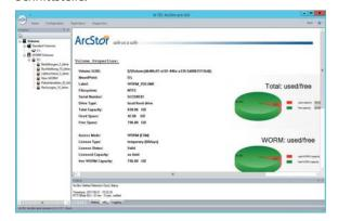
Für die Überwachung des Status der WORM Volumes und der Aktivität auf dem ArcStor pro steht dem Anwender die AcrStor pro GUI zur Verfügung. Damit können die Volume Eigenschaften, der Komponenten Status und die VRC Informationen überprüft werden. Außerdem bietet die GUI einen Überblick über die Replikations-Aktivität und das File System.
